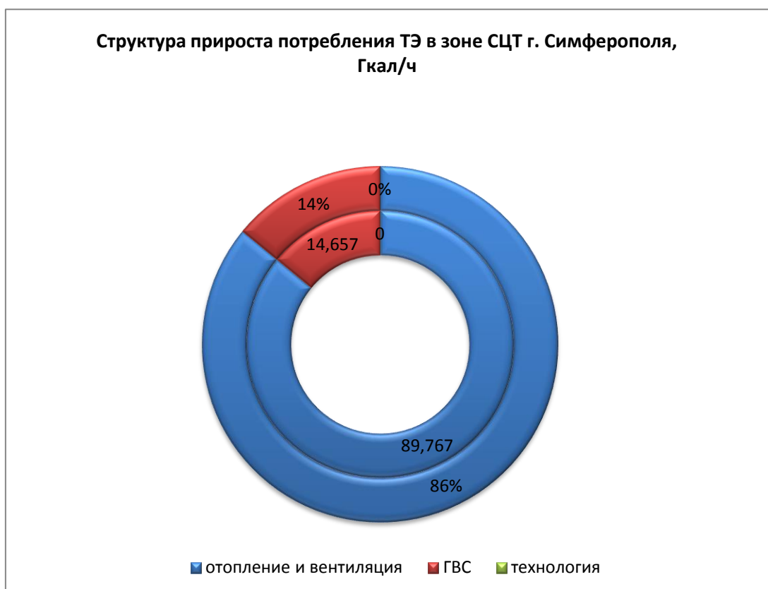
Рисунок 6 Структура прироста потребления тепловой мощности по видам теплопотребления на расчетный период разработки схемы теплоснабжения
