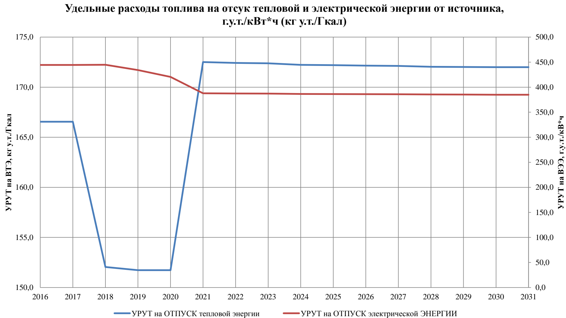
Рисунок 75 Удельные расходы условного топлива на тепло и электроэнергию Симферопольской ТЭЦ
